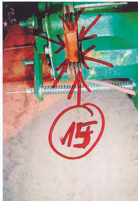
Verrostete Antriebsbremse bei neuem Antrieb
